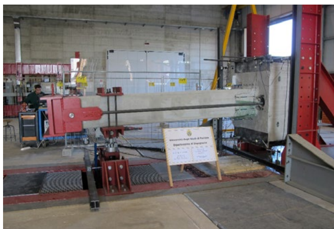
Prova di carico ciclico in corso presso il LaPIS
