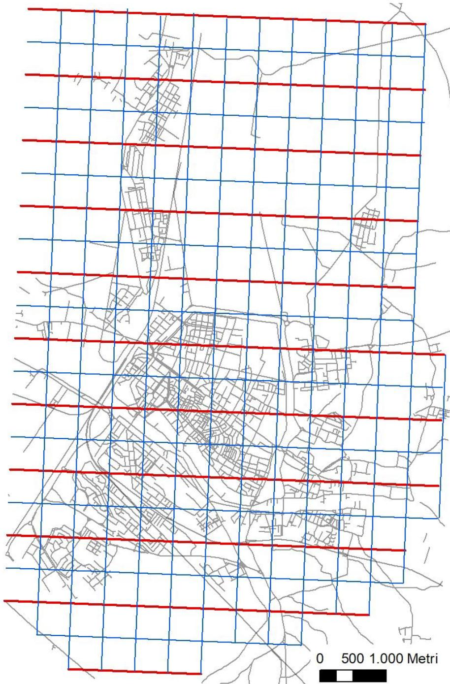
**Figura 7-8 - Reticolo ortogonale di piani verticali utilizzato per la rappresentazione grafica del modello tridimensionale di sottosuolo. In rosso sono indicate le tracce dei profili illustrati in Figura 7-10.**
