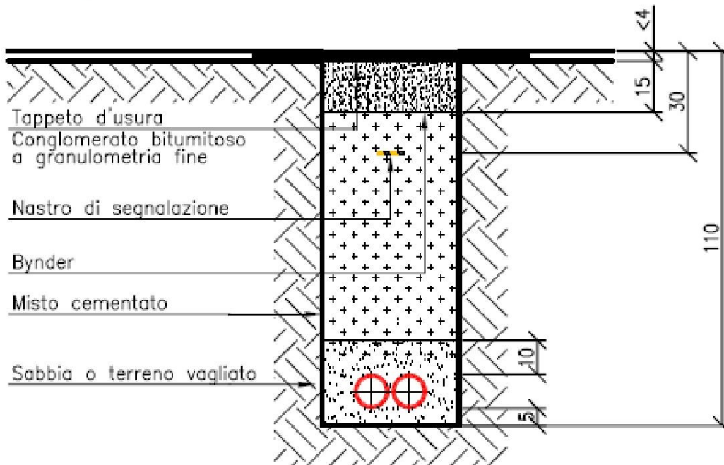
Figura B - Sezione tipo scavo tradizionale su marciapiede.
